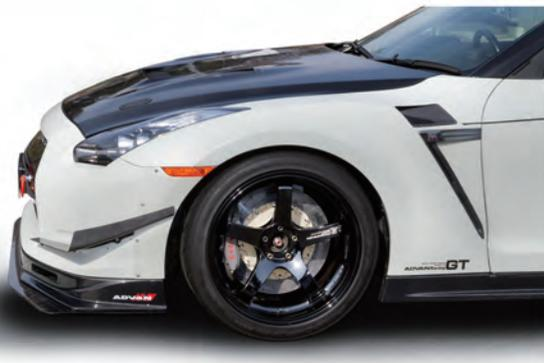
エアアウトレットは、サイドダクトの延長上に配置。機能面だけでなく、部分的にカーボン素材を取り入れることで、サイドビューにワンポイントを追加。付属のウインカーは薄型 LED の専用設計で、オレンジカラーが視認性を向上させます。
