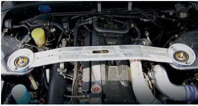
SKYLINE GT-R/BNR32 ●アルミオーバーシャフト(目の字断面 ツインシャフト)
