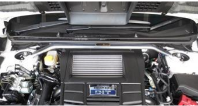
LEVORG/VMG ●アルミオーバーシャフト(目の字断面)
