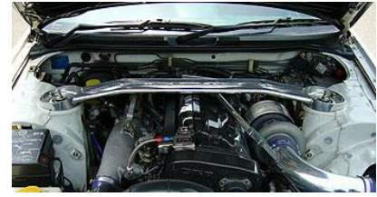
SKYLINE GT-R/BCNR33.BNR34 ●アルミオーバーシャフト(目の字断面 ツインシャフト)
