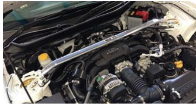
86.BRZ/ZN6.ZC6 ●アルミオーバーシャフト(目の字断面)
