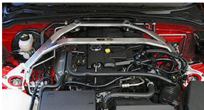
ROADSTER/NCEC ●アルミオーバーシャフト(目の字断面)
